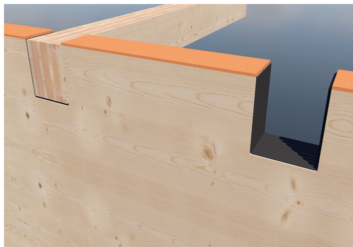
Gebruik van Silent EPDM-ontkoppelingsband onder balken voor geluiddemping tussen houten componenten.
