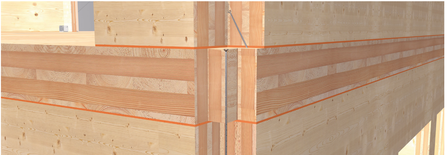
Verbinding van wand en houten vloer in bovenverdieping
