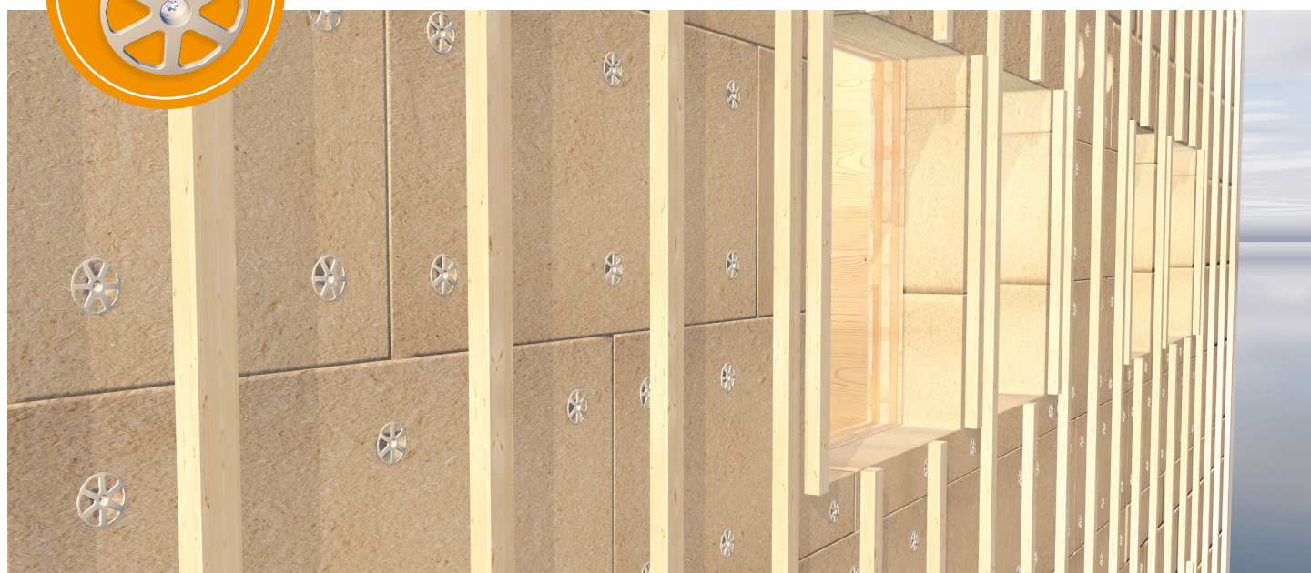
Klimax ter bevestiging van isolatiemateriaal
