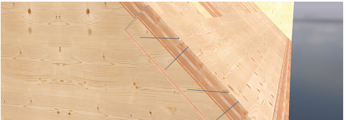
Verbinding van dak- en wandelement
