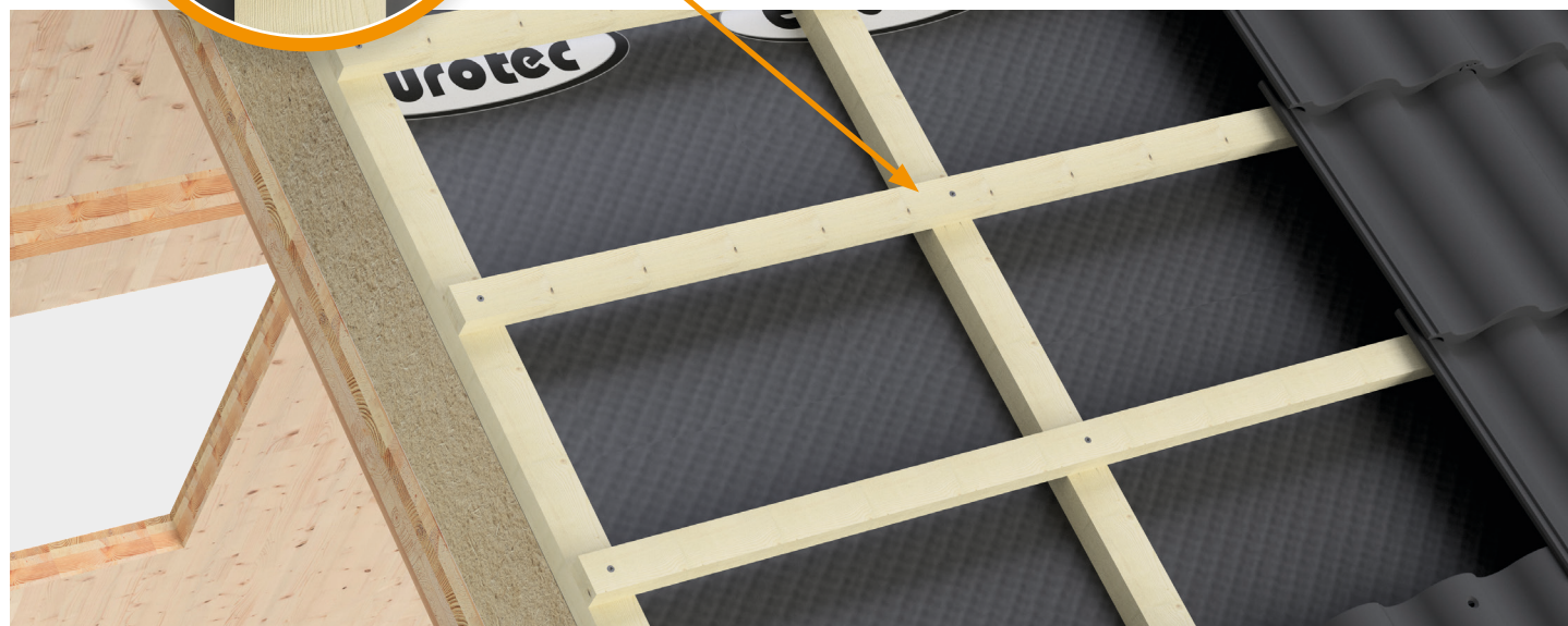
Paneltwistec AG ter bevestiging van draaglatten
