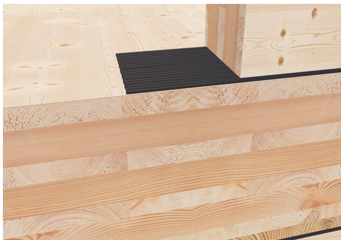
Silent EPDM-ontkoppelingsband voor materiaalscheiding en geluidsisolatie.
