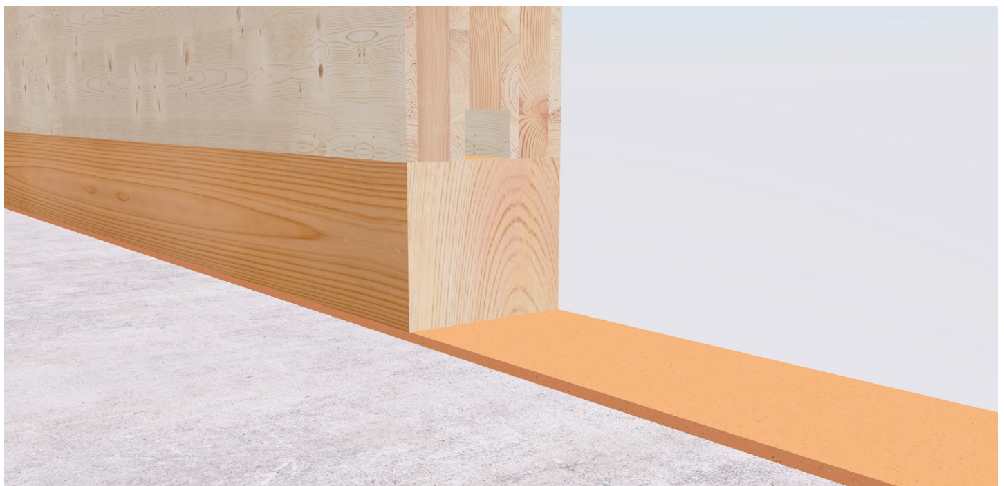
SonoTec voor de scheiding en geluidsisolatie van fundament en dorpelhout
